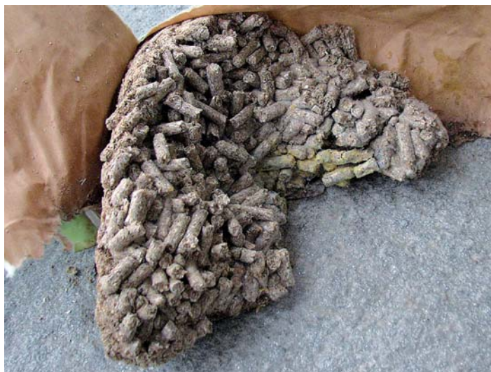
Abb. 3: Auch Pellets verderben bei feuchter Lagerung rasch (Schimmelbefall)
